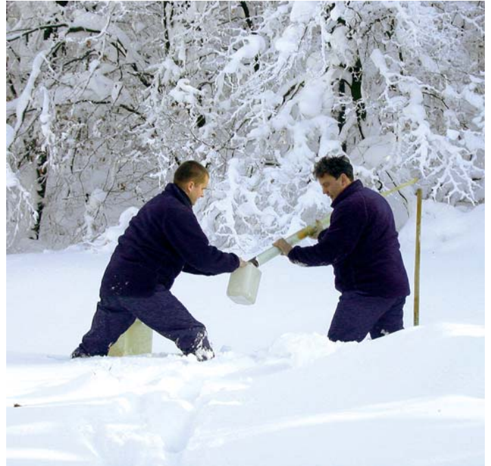
Bild 23: Schneedichtemessung im Gelände zur Ermittlung des im Schnee zwischengespeicherten Wasservolumens Fig. 23: Field measurement of snow density and depth to determine the snow water equivalent
