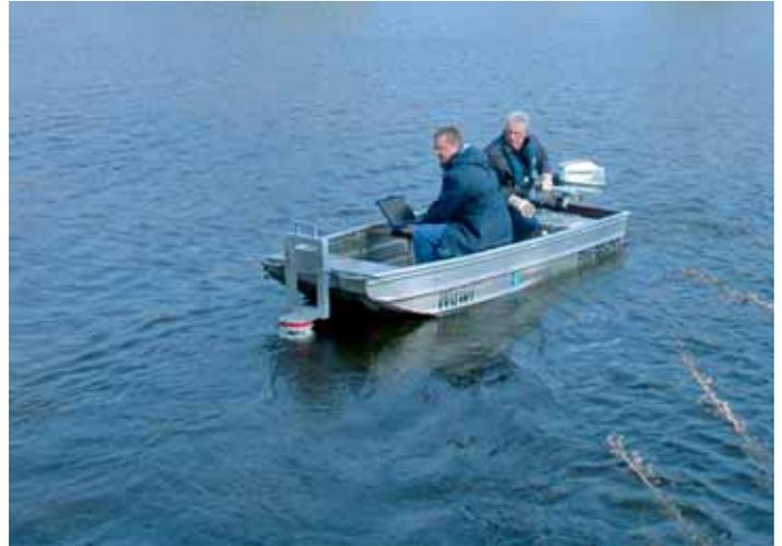
Bild 23: ADCP-Messung mit Messboot
