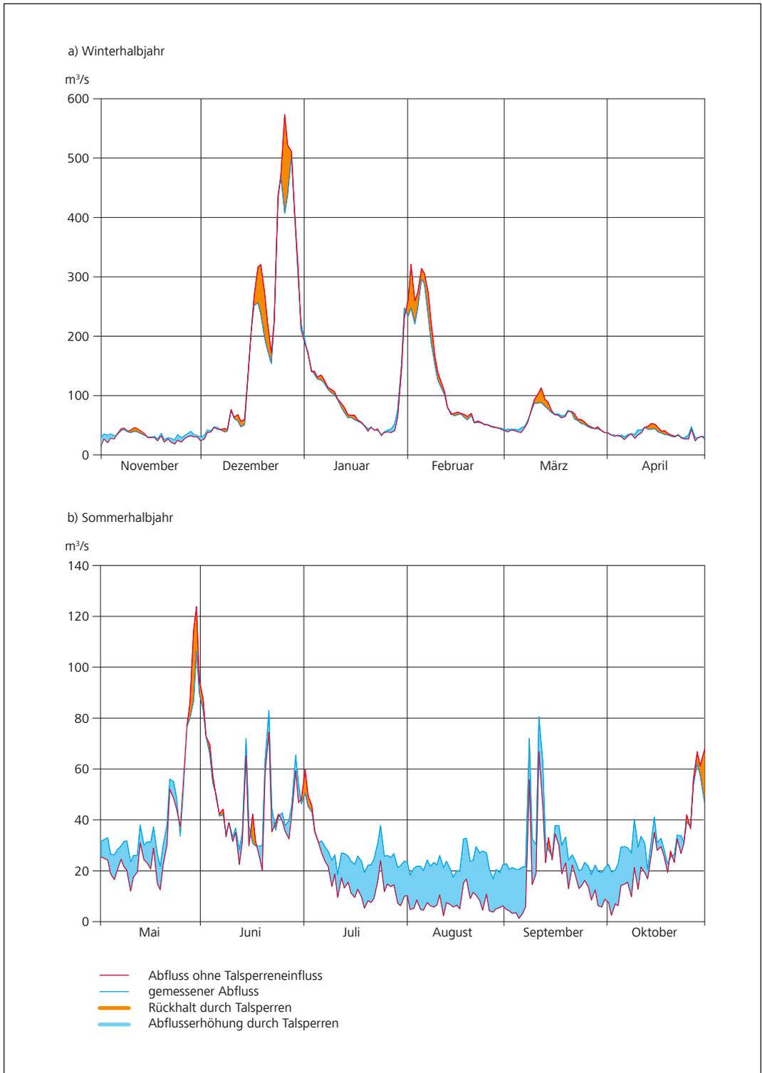
Bild 12: Auswirkung der Talsperren auf das Abflussgeschehen (Tagesmittelwerte) an der Ruhrmündung im Abflussjahr 2013
