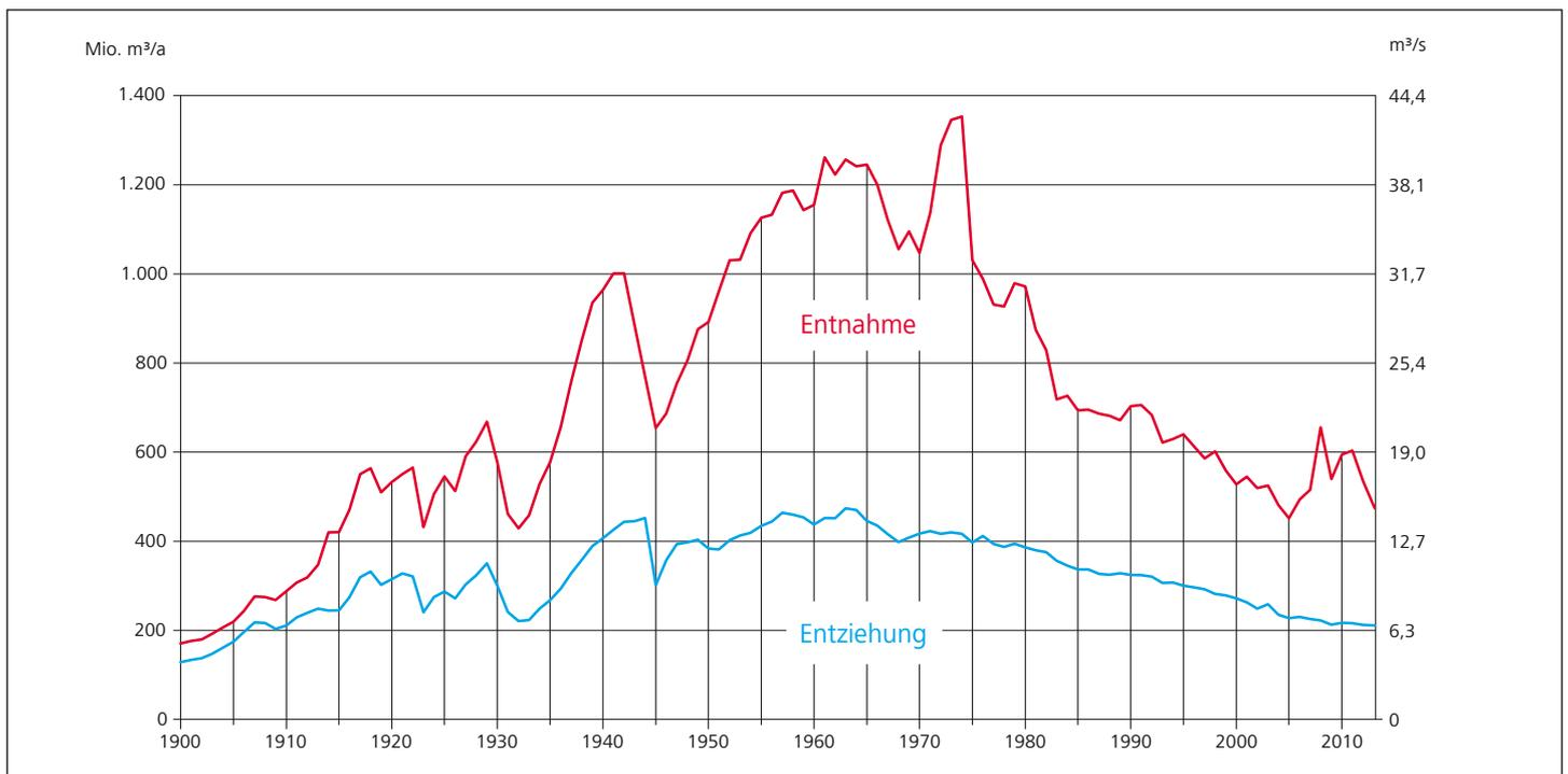
Bild 9: Jahreswerte der Entnahme und Entziehung im Einzugsgebiet der Ruhr von 1900 bis 2013
