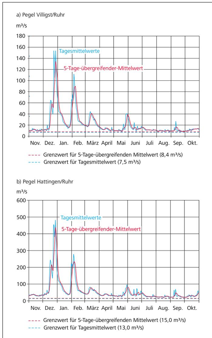
Bild 7: Ganglinien der Tagesmittelwerte und der 5-Tage-übergreifenden Mittelwerte des Abflusses im Abflussjahr 2013
