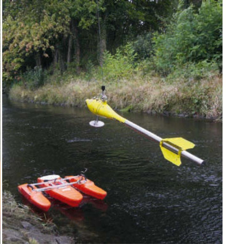
Abflussmessung mit einem ADCP-Messgerät während des Anwendertreffens am Pegel Günne/Möhne.
