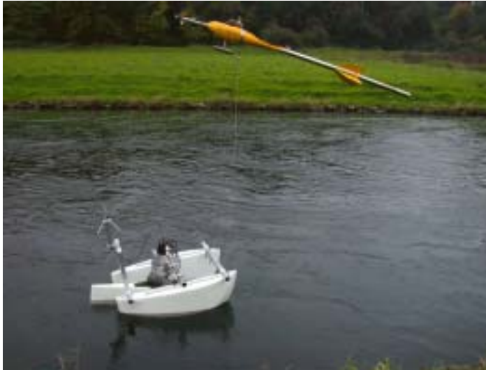
Bild 25: ADCP-Katamaran im Einsatz an der Seilkrananlage am Pegel Hattingen Fig. 25: ADCP-catamaran mounted on the cable way of the gauging station at Hattingen
