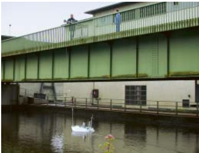
Bild 26: ADCP-Messung mit einer mobilen Seilkrananlage Fig. 26: ADCP measurement using a mobile cable way
