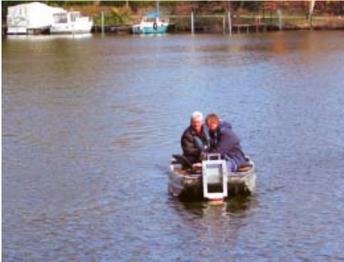
Bild 22: Messboot mit im Bug montiertem Messgerät im Einsatz Fig. 22: Measuring boat with ADCP mounted in the bow
