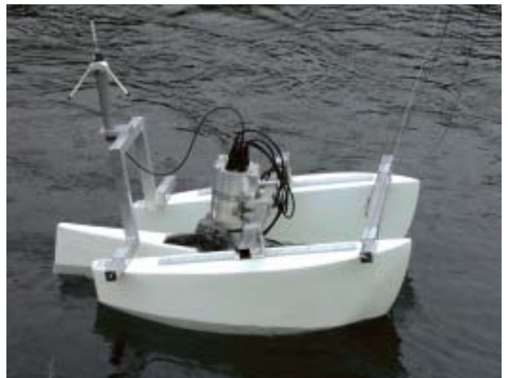
Bild 24: Katamaran-Trägerschwimmkörper mit Messgerät und Funkantenne Fig. 24: Catamaran floating body with ADCP and radio antenna
