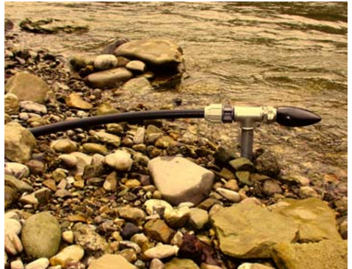
Bild 30: Neu entwickelter strömungsgünstiger Ausperltopf Fig. 30: Newly developed bubble orifice
